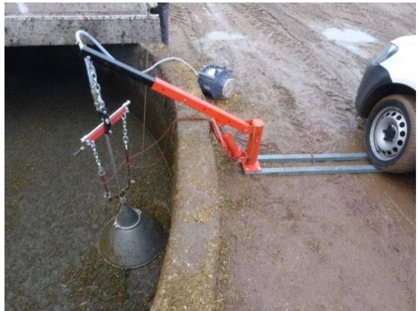
Abbildung 6: Querschnitt des Gassammlers (links) und Gassammler im Einsatz an einer offenen Vorstufe (CAD-Zeichnung: ttz Bremerhaven 2016)
